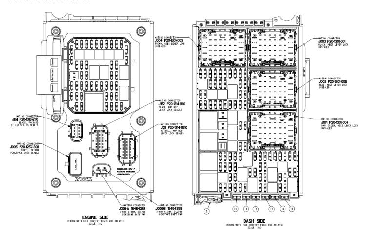
IMAGE SHOWN FOR REFERENCE ONLY, SEE THE CHASSIS SPECIFIC CAB PDC FUSE LABEL
